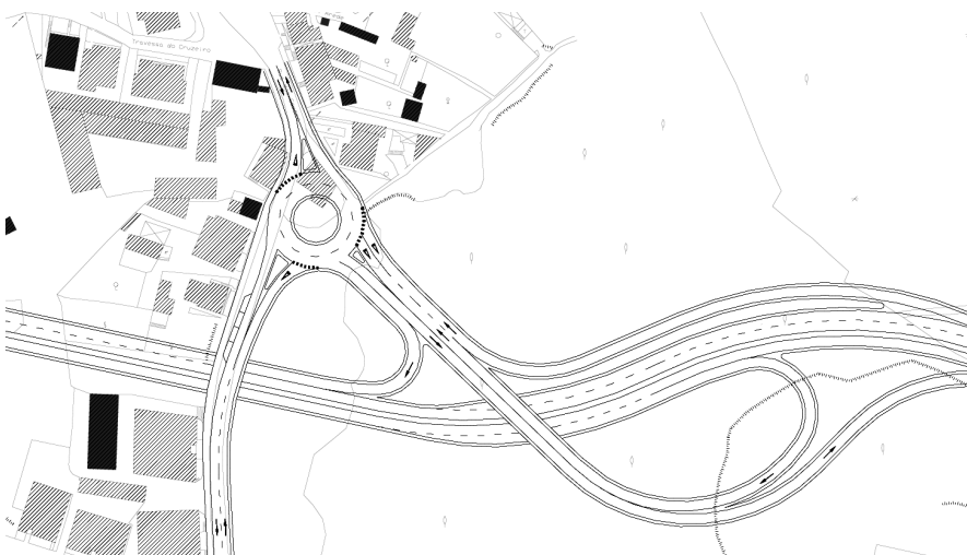
Figura 44 - Exemplo de cruzamento parcialmente desnivelado em ambiente suburbano
