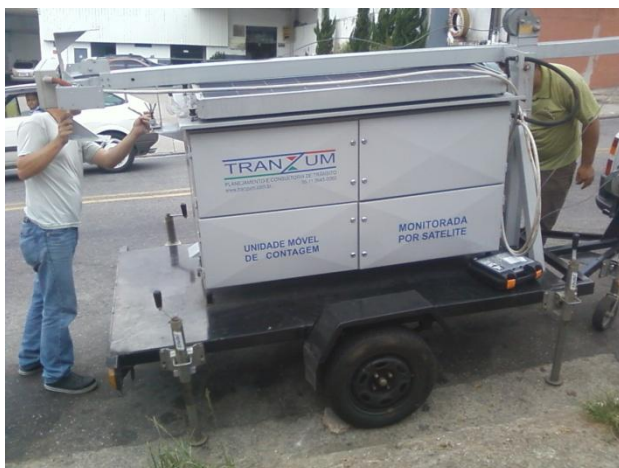
Figura 32: “Carrinho” de filmagens – instalação da unidade móvel de contagem, com apoios fixados no pavimento.
