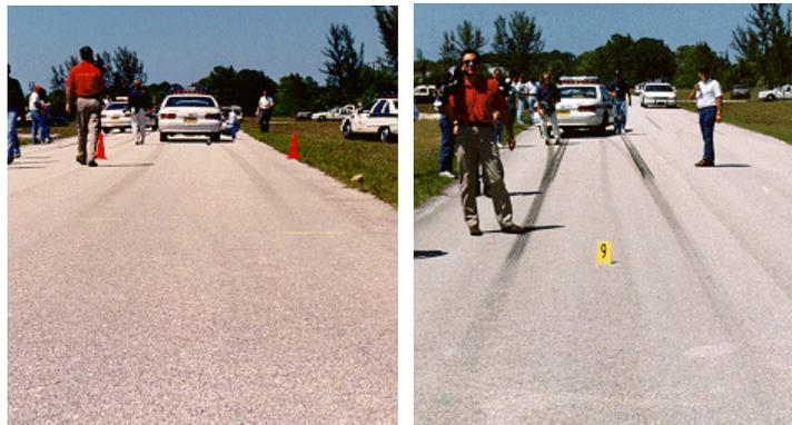
Figura 13. Marcas de frenagem. Veículo a 80 km/h com ABS ativado e desativado, respectivamente.
