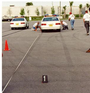
Figura 5. Marcas produzidas por veículo com ABS ativado.
