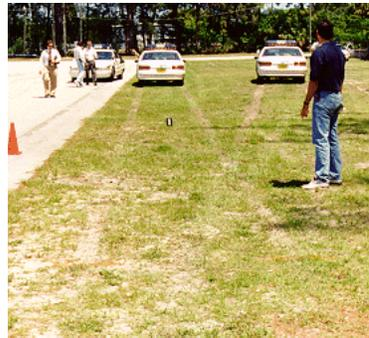
Figura 11. Marcas produzidas por veículo com ABS ativado e desativado, respectivamente.
