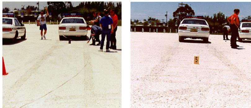
Figura 9. Marcas produzidas por veículo com ABS ativado e desativado, respectivamente.
