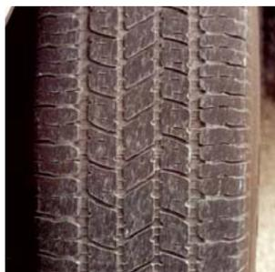
Figura 14. Superfícies da banda de rodagem salpicada com marcas oblongas, orientadas longitudinalmente.
