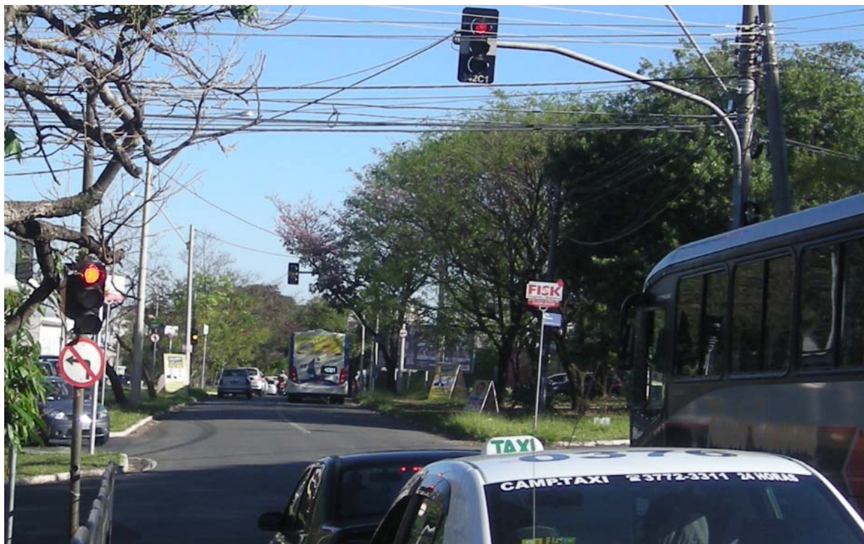
Mesmo com grande fluxo e velocidade reduzida, o ônibus passa de modo seguro à frente. Note que pela programação após 04/07/13, entre o início do amarelo na primeira aproximação (intervalo 2) e o término do amarelo na segunda aproximação (intervalo 4) temos um total de 12 segundos – tempo que proporciona a passagem dos veículos, evitando transtornos no local, principalmente nos horários de pico
