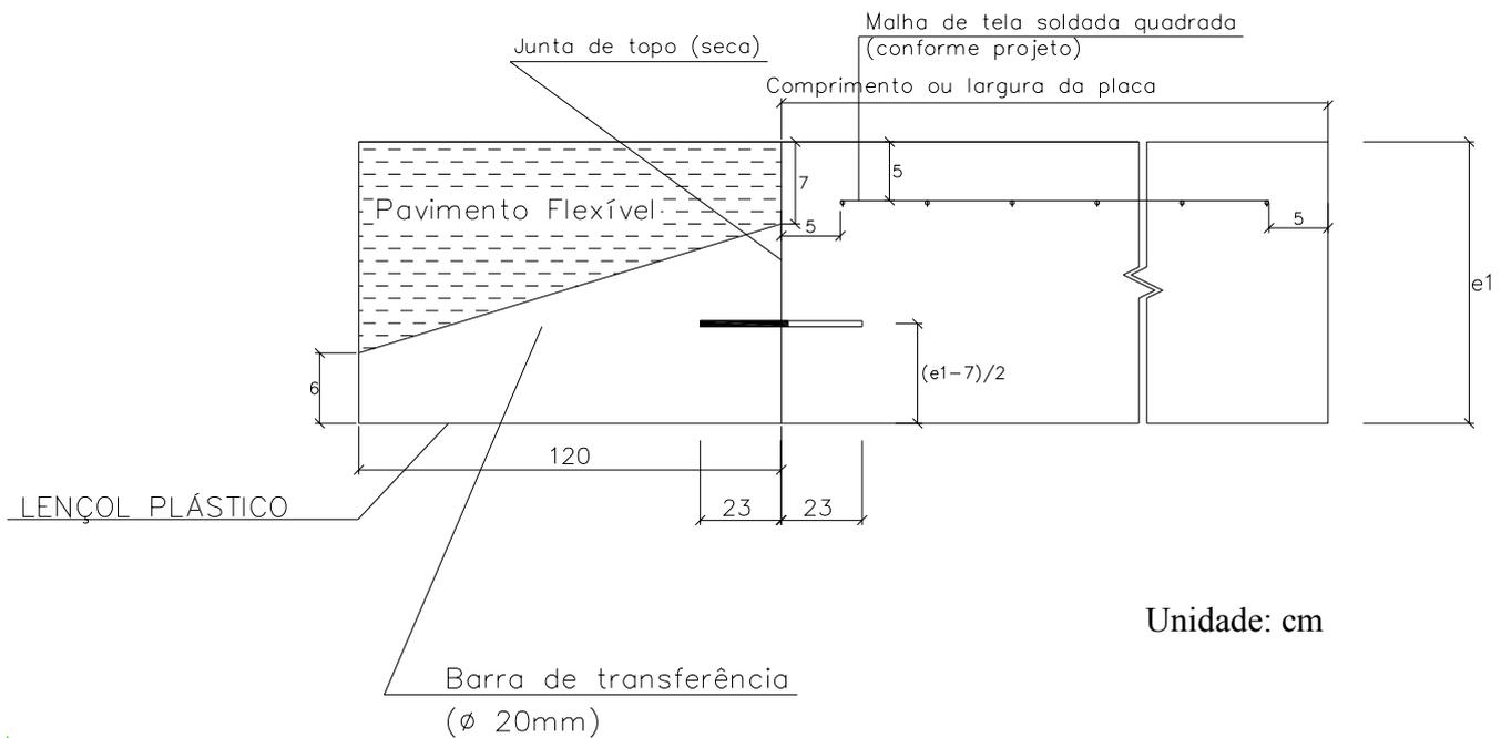
Junta transversal de construção – transição entre os pavimentos rígido e flexível.
