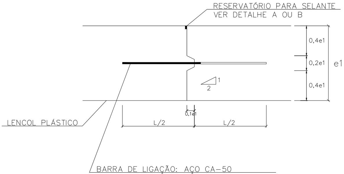
JUNTA LONGITUDINAL DE CONSTRUÇÃO, DE ENCAIXE, TIPO MACHO-E-FÊMEA, COM BARRAS DE LIGAÇÃO.
