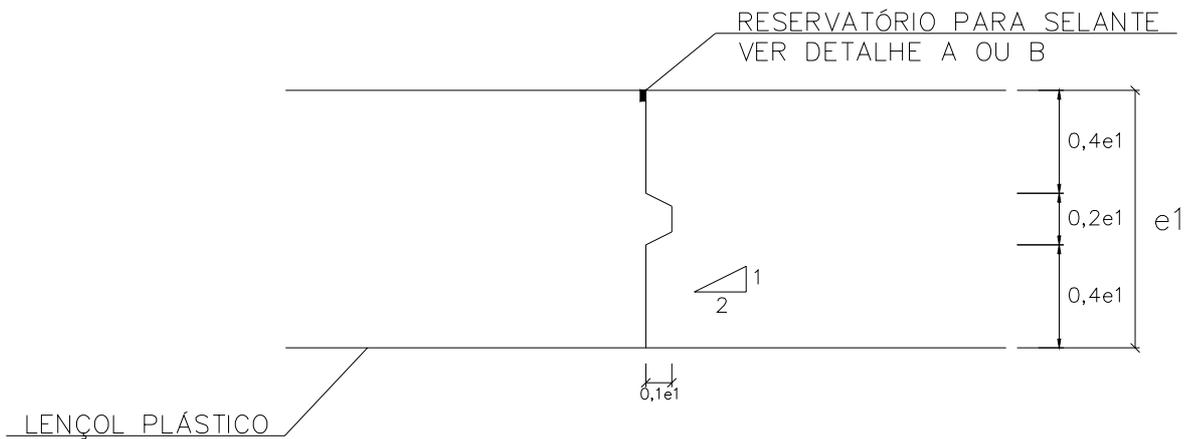
JUNTA LONGITUDINAL DE CONSTRUÇÃO, DE ENCAIXE, TIPO MACHO-E-FÊMEA.
