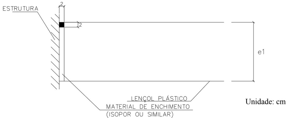
JUNTA DE EXPANSÃO NOS ENCONTROS DO PAVIMENTO COM OUTRO TIPO DE ESTRUTURA (BOCA-DE-LOBO, PV, ETC)
