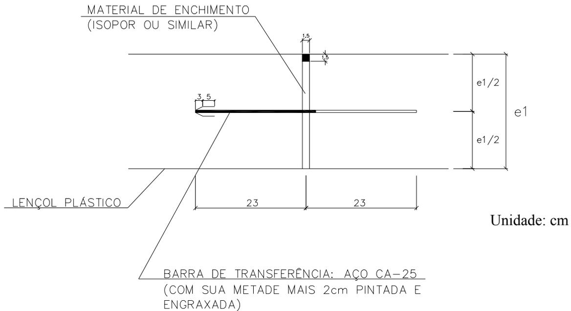
JUNTA TRANSVERSAL DE EXPANSÃO, COM BARRAS DE TRANSFERÊNCIA E CAPUZ.
