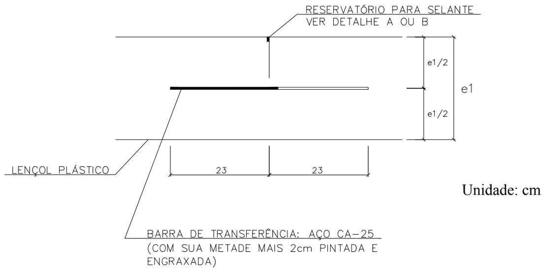
JUNTA TRANSVERSAL DE RETRAÇÃO, SERRADA, COM BARRAS DE TRANSFERÊNCIA.
