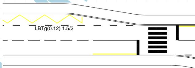
Figura 4. 6 - Paragem de transportes públicos com gare e passagem para peões associada
