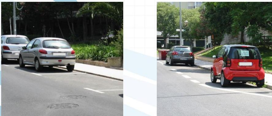
**Figura 4. 5 -** Marcação correcta (à esquerda) e incorrecta de estacionamento longitudinal
