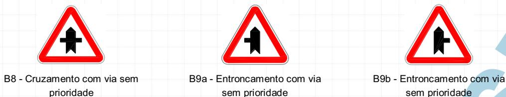
**Figura 3. 21** - Sinais de cruzamento e de entroncamentos de nível
