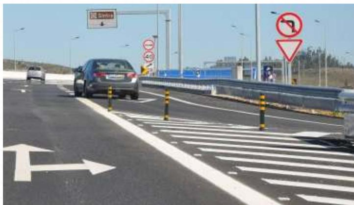
Figura 2. 5 - Exemplo de utilização de “balizas cilíndricas” em “zonas mortas”
