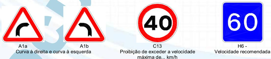
Figura 3. 35 - Sinais de código mais usados em secção corrente de ramos de ligação
