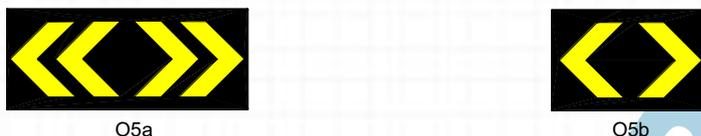
Figura 3. 19 - Baias direccionais para balizamento de pontos de divergência
