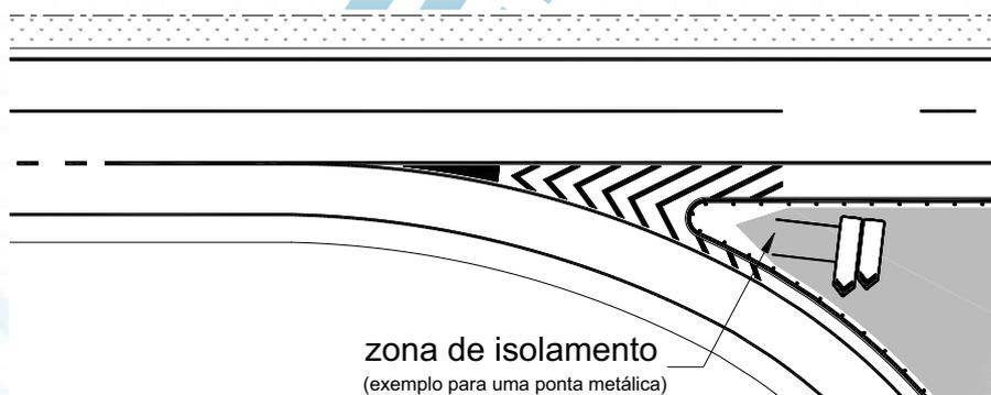
Figura 3. 20 - Colocação longitudinal de setas de direcção em nós de ligação
