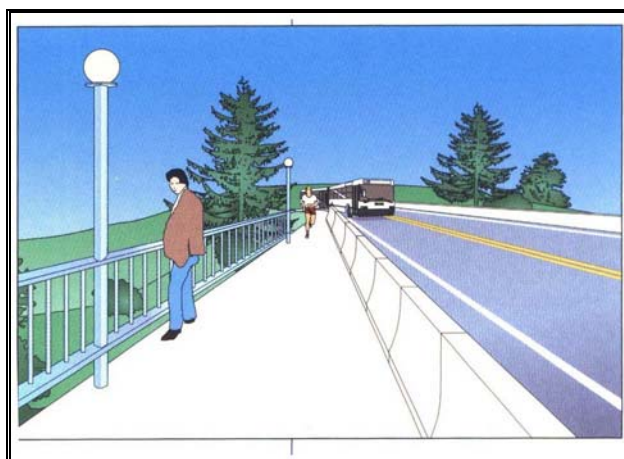
Figura 13 - Viaduto com Barreira Protetora
